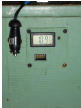
Allume-cigare et thermomètre. En-dessous, une ouverture pour réglage du thermostat.
